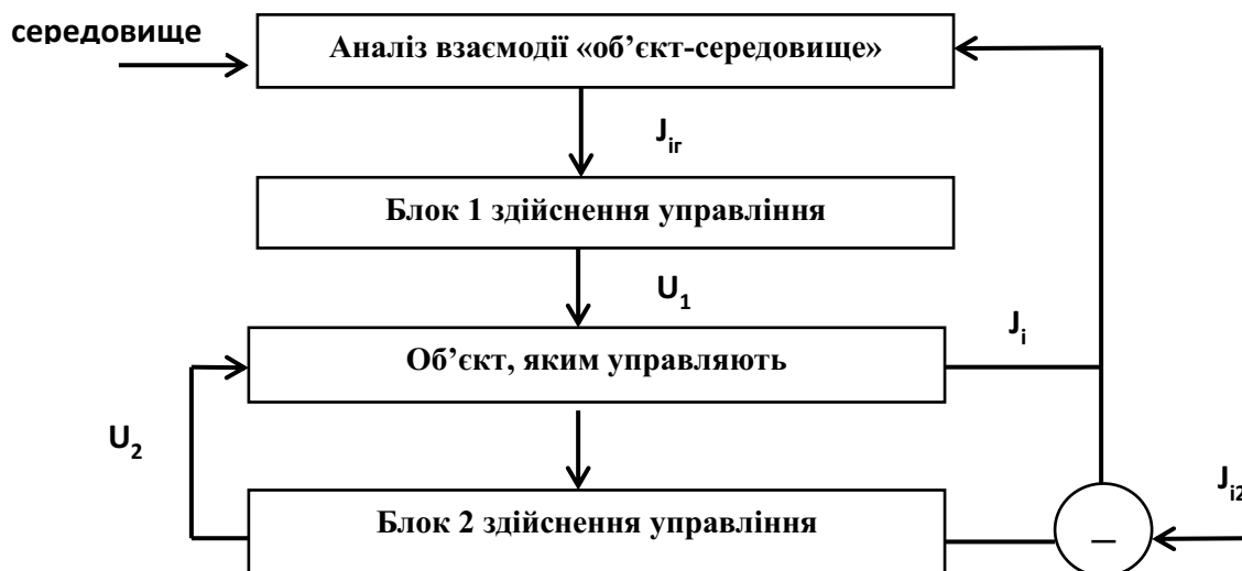
Рисунок 1.6 – Комбінована схема управління безпекою руху
